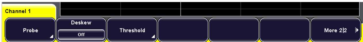
Bild 5-2: Über das Menü "Probe" gelangt man zum Untermenü. Die Taste "More" dient zum Weiterschalten der Menüseiten
